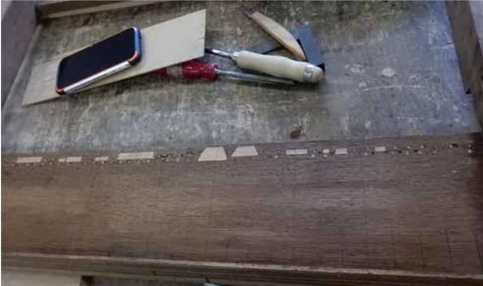
Nachdem mehrere Schichten von Filz- und Papiergarnituren entfernt worden waren, traten zahlreiche Löcher hervor, die auf den mindestens zweimaligen Austausch der Tastenführungsstifte schließen lassen. Diese Löcher mussten geschlossen werden, um neue Stifte in der Bauart von Stumm einsetzen zu können.
