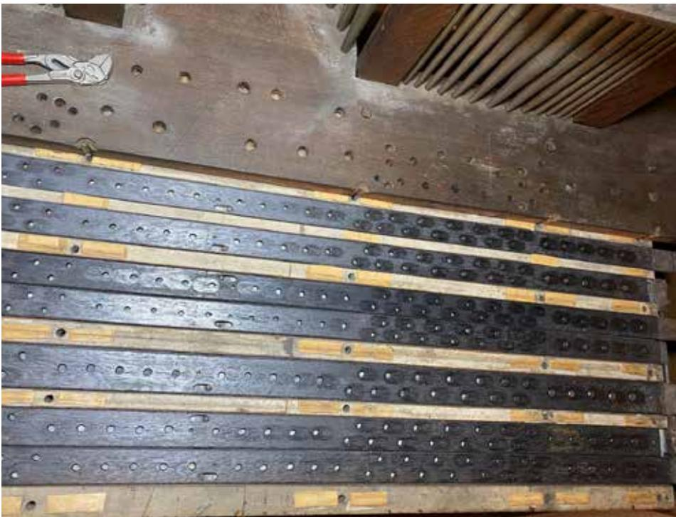
Dieselbe Windlade bei abgehobenen Pfeifenstöcken, Blick auf die Schleifen
